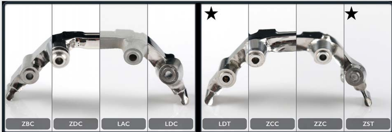
► Abb. 4 a und b Fotomontage mit Ausschnitten aller untersuchten gefrästen Stege von basal. * markiert die aus Titan gefertigten Stege.
