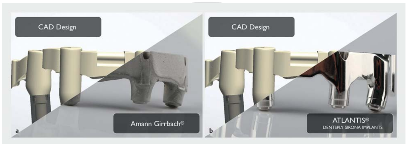
► Abb. 2 a und b Beispiele der CAD-Planung und des fertigen CAM-gefrästen Stegs.
